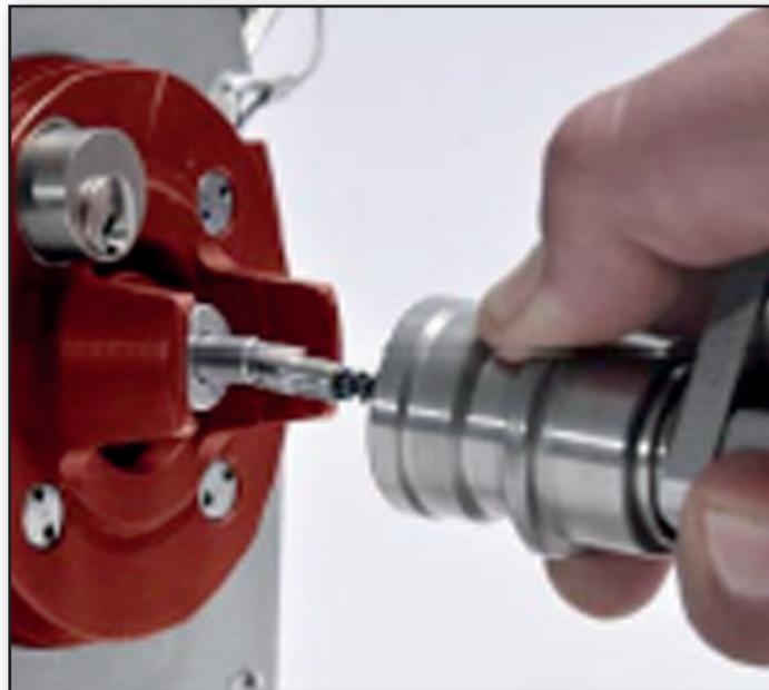
Una vez liberado el manguito exterior, el acople se conecta automáticamente. (Fig. 12).
