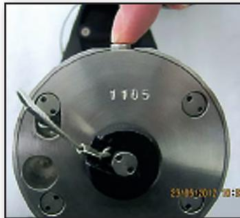
Ya que es una tapa bajo presión, este se eyecta automáticamente una vez presionado el perno (Fig.6).
