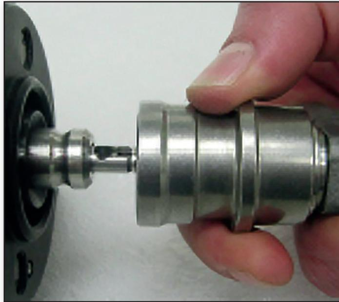
Una vez liberado el manguito exterior, el acople se conecta automáticamente. (Fig. 11).
